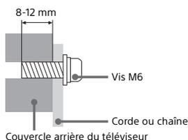
**3** Fixez le téléviseur au mur avec des boulons, un dispositif d'ancrage au mur et une chaîne (ou une corde).
