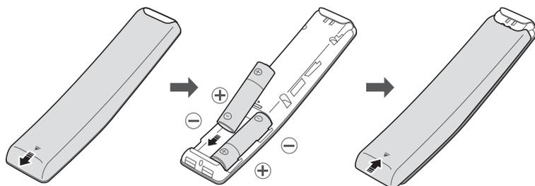
Pour installer les piles, ouvrez le couvercle à l'arrière dans le sens indiqué par la flèche et insérez les piles conformément à l'illustration. Assurez-vous que les polarités positif et négatif donnent dans le bon sens.
