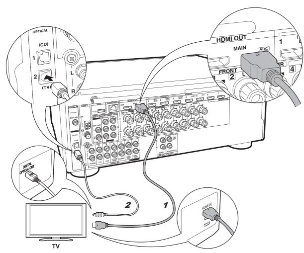
1 HDMI cable, 2 Digital optical cable
